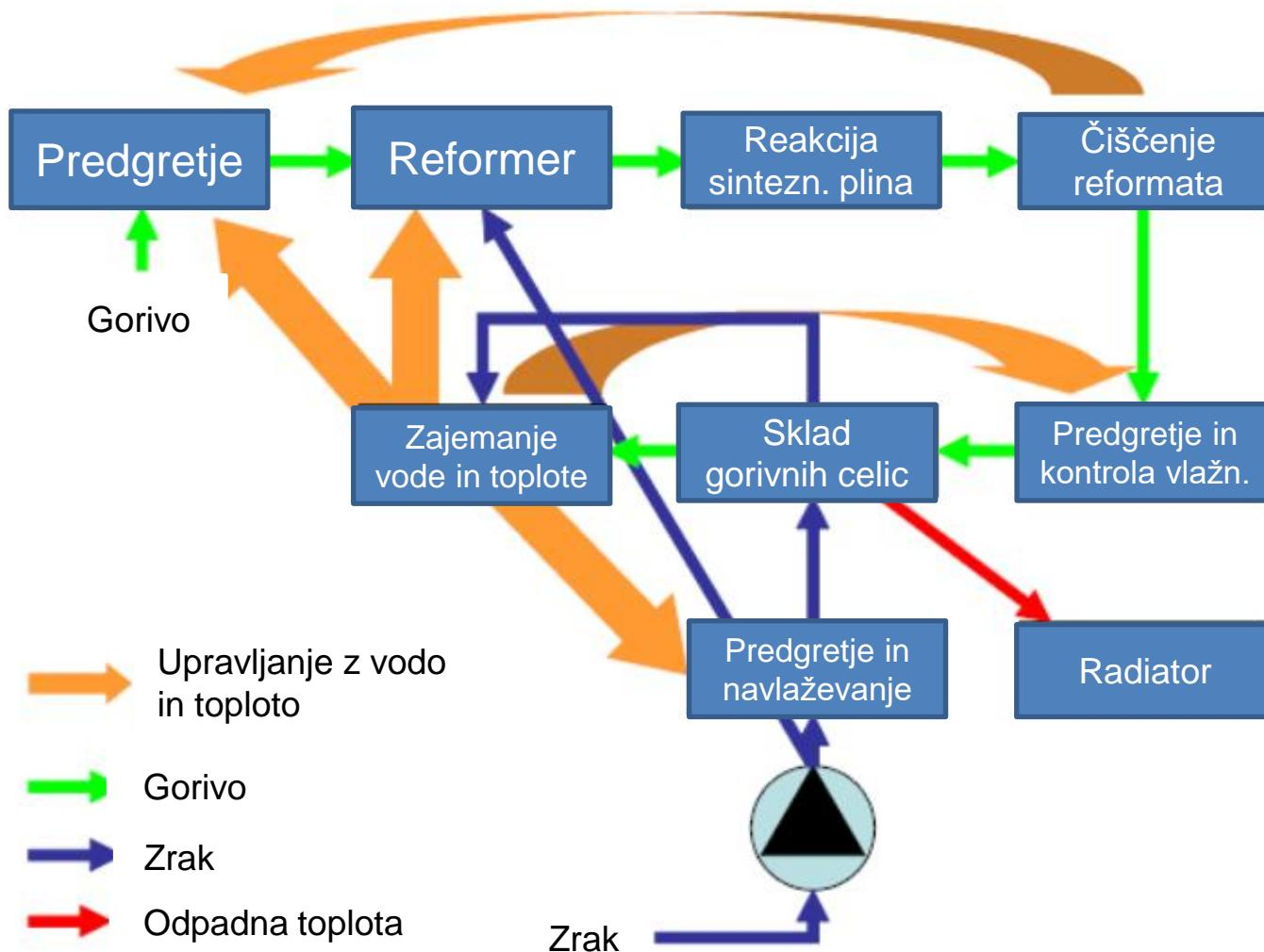
Shematski prikaz procesov v tipičnih gorivnih celicah, ki so zasnovane na reformerju
