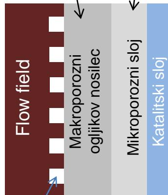
Pretočni kanal      300-400 μm      10-100 μm      10-50 μm
